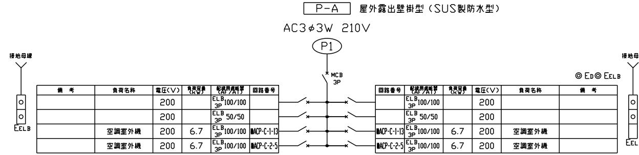
動力盤(P-A)結線図(既設)
