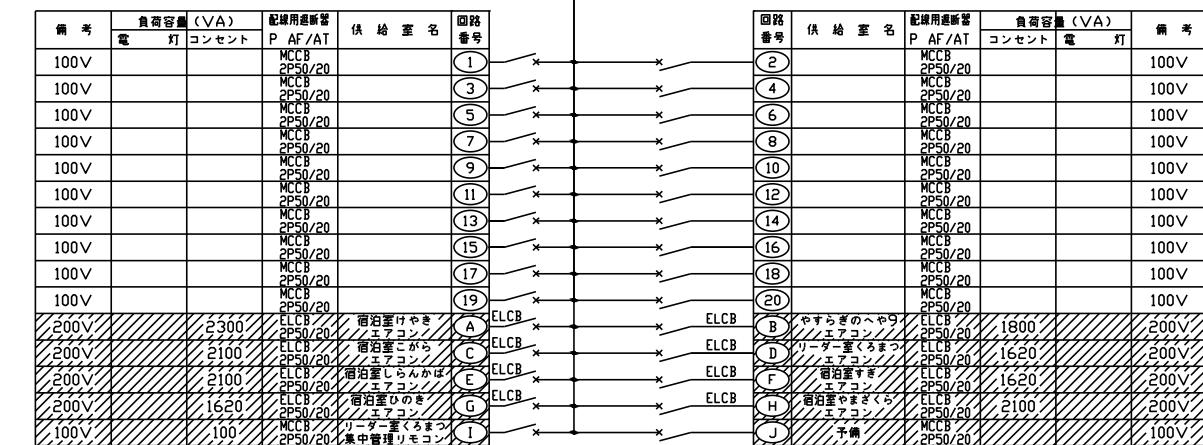
分電盤(L-A)結線図(改修後)
