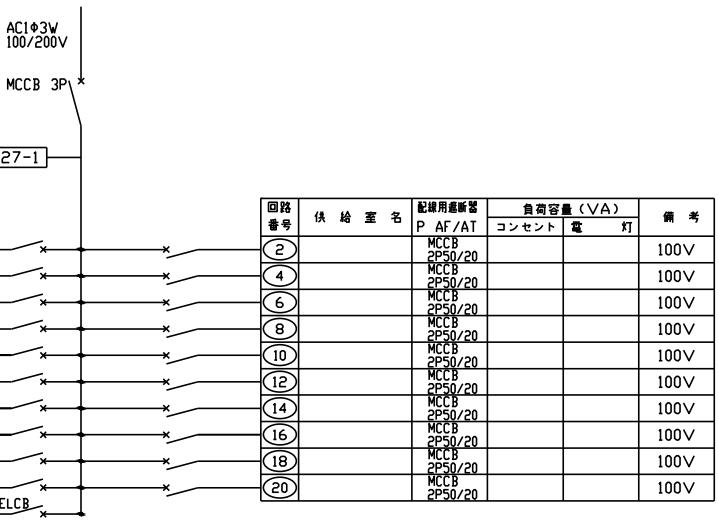
分電盤(L6-LGK)結線図(既設)
