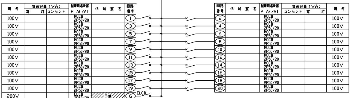
分電盤(L6-LGK)結線図(改修後)
