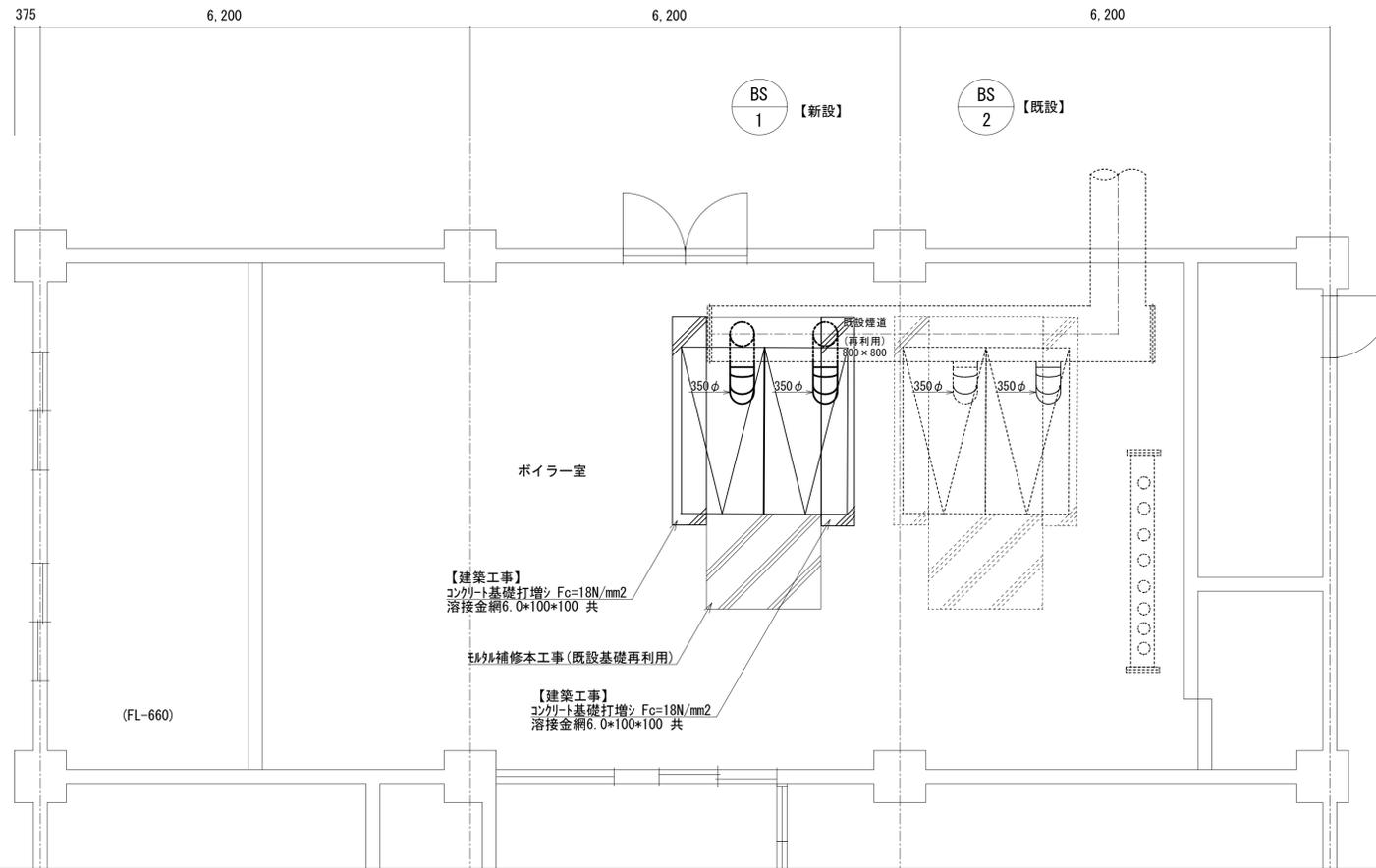
煙道平面詳細図 (改修後) S=1:50
