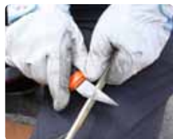
ナイフを持つ手を固定し、竹の方を動かすとけずりやすい
