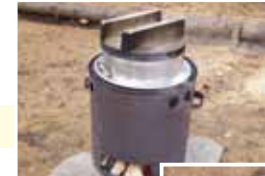
ブロックかまどを 組むときは、羽釜 の羽がかかる程度 の幅にする
