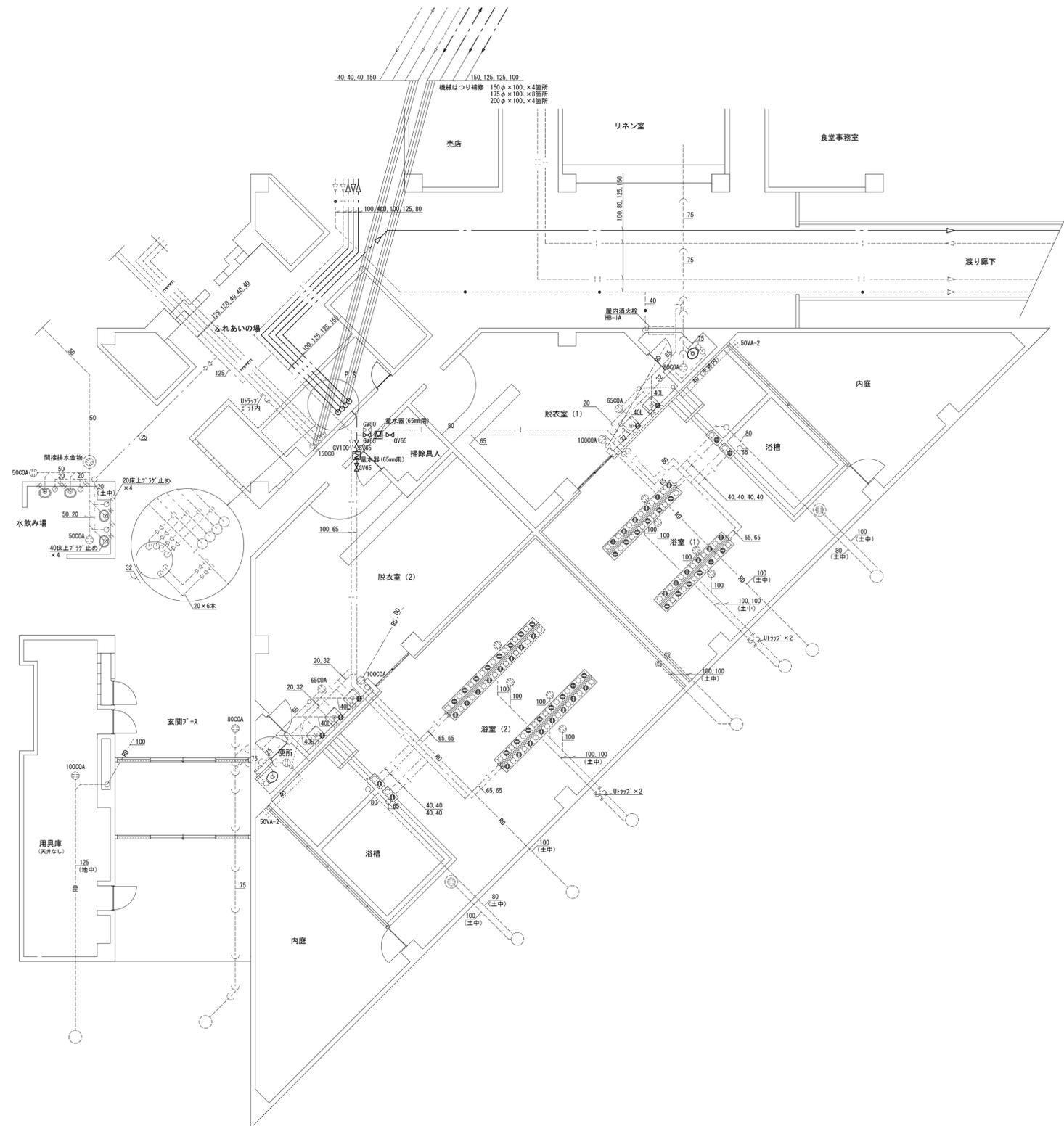
給水設備 生活関連棟PS廻り平面詳細図 (改修後) S=1/100
