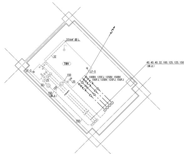
給水設備 高置水槽室廻り平面詳細図(改修後) S=1/100
