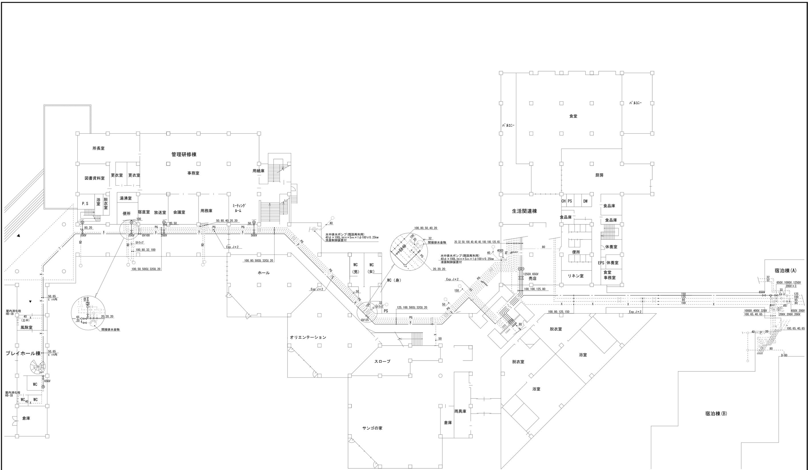
給水設備 び'ツ内配管平面図(改修前) S=1/200
