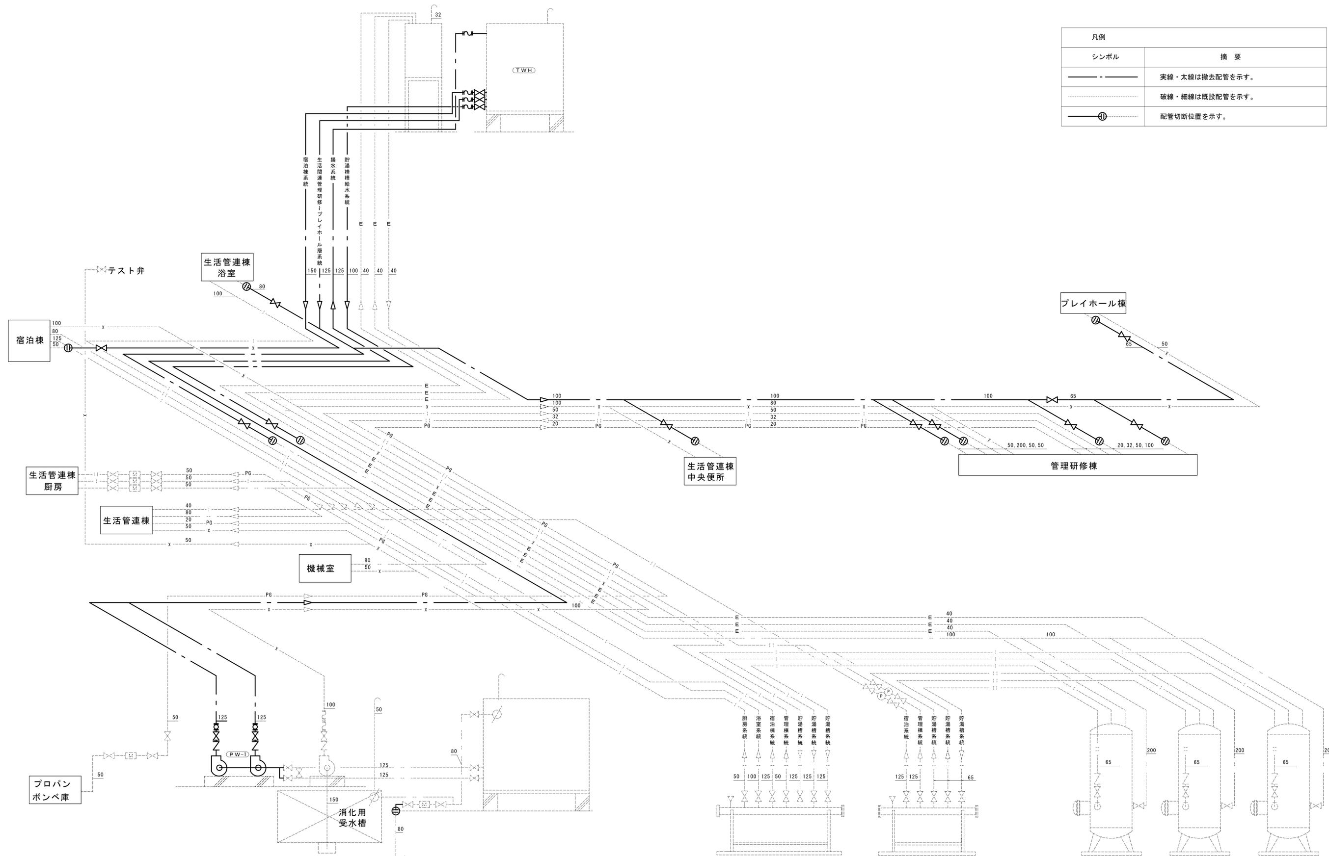
給水設備 系統図(改修前) N/S
