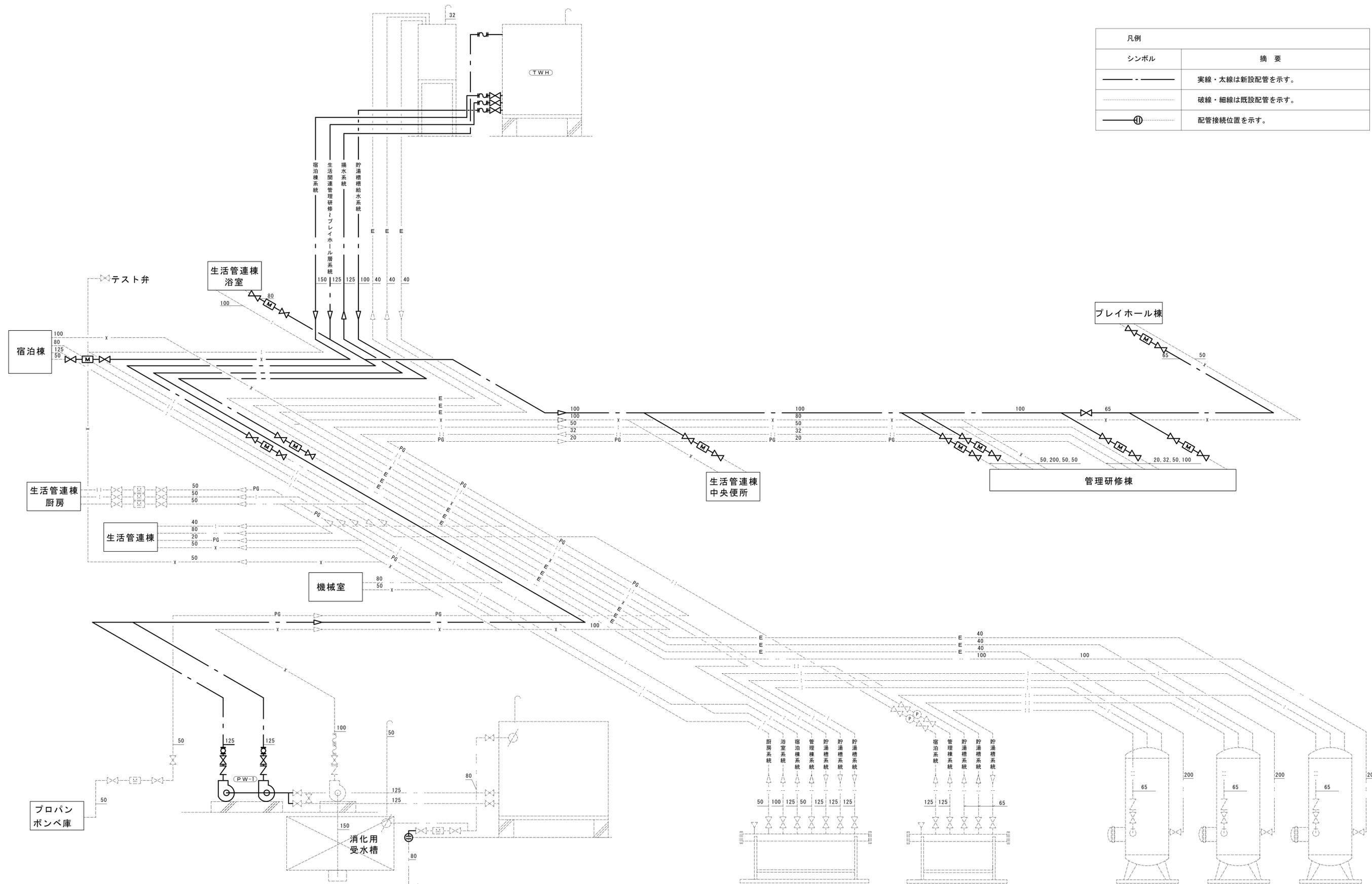
給水設備 系統図(改修後) N/S
