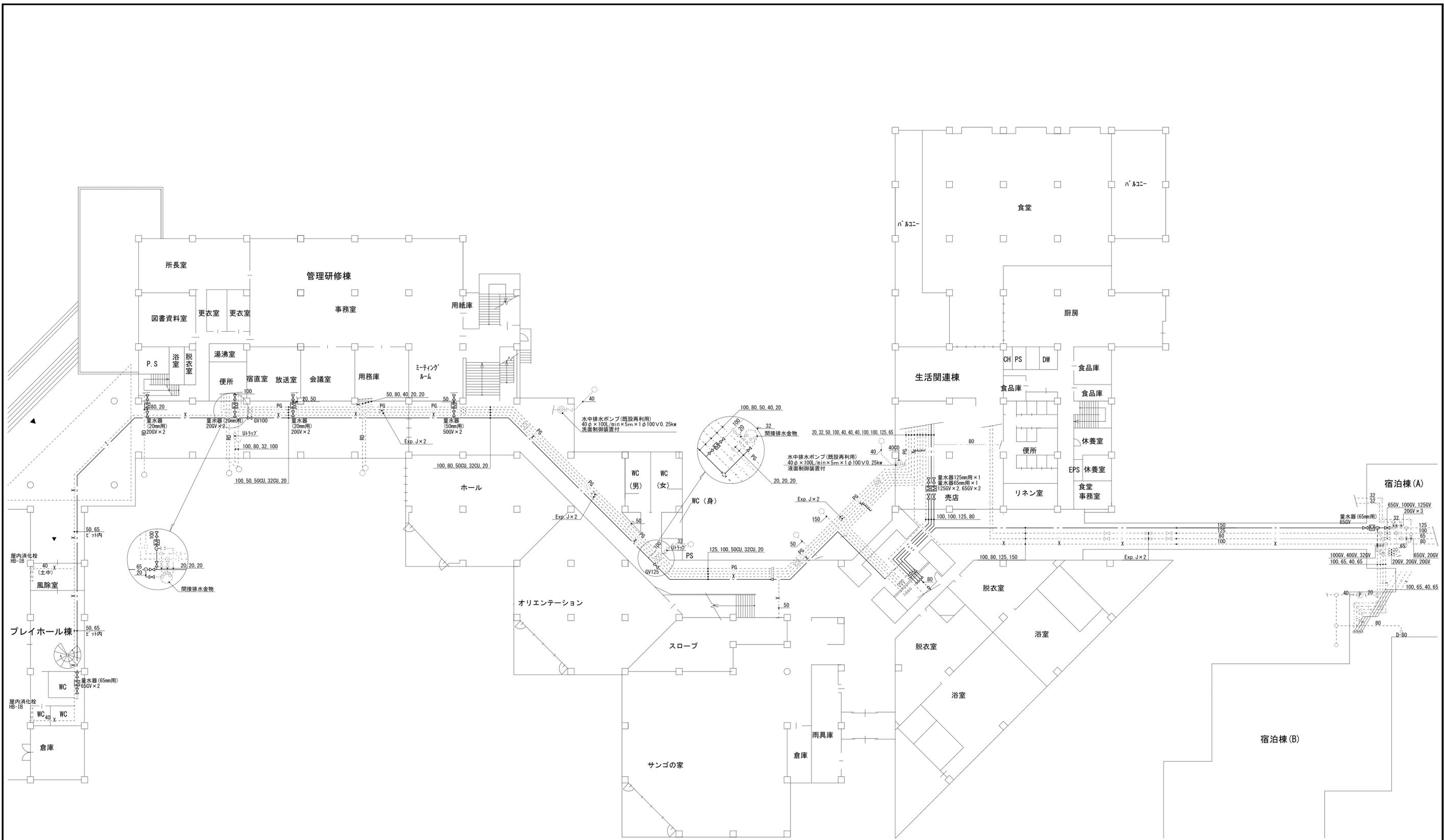
給水設備 び'ット内配管平面図(改修後) S=1/200
