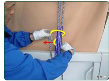
右手で持っている部分を写真(30)のように、荷物を抑えているロープの向こう側に通し...
