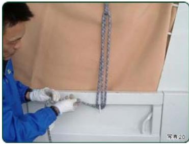
十分に引っ張ったロープを写真(28)のようにもう一度荷台のフックにかけ...
