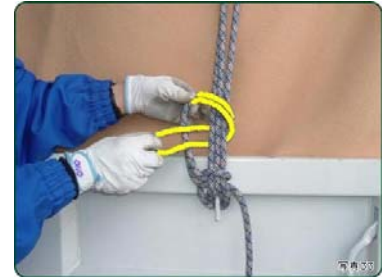
写真(33)のように荷物を抑えているロープに結びつけていきます。 ※それでも端末が長いようであればこの作業を繰り返します。
