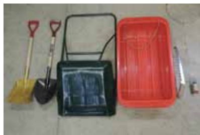
▲あると便利な道具（左から先が四角いスコップ、先が尖ったスコップ、スノーダンプ、ソリ、スノーソー、左官ゴテ）
