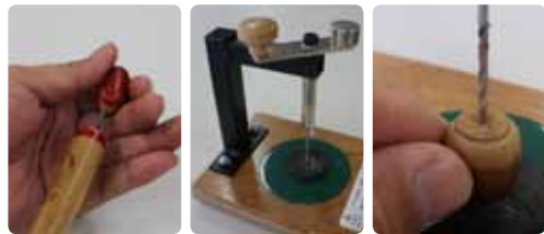
手元がぶれないように、ドングリの穴開け機しっかりおさえて
